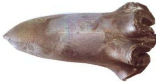
圖四 具尾翼穩定之 EFP (圖片來源：DRDC Suffield Website)
